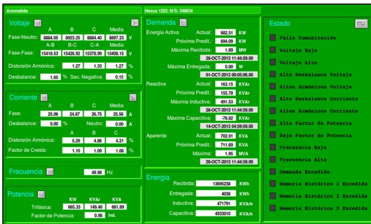
Sistema de Información Energética (SIE). Variables eléctricas de acometida. Estado de alarmas. © Gerencia Energética, S.L.
