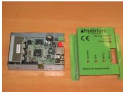
Figura 1.3. Controlador actual del poste de recarga
