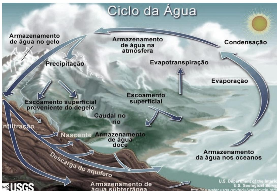
**Figura 3 - Esquema representativo dos processos e elementos envolvidos no ciclo da água. Fonte: U. S. Geological Survey**
