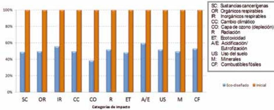
Figura 21. Comparación entre componente inicial vs prototipo mediante el método Eco-indicador'99.
