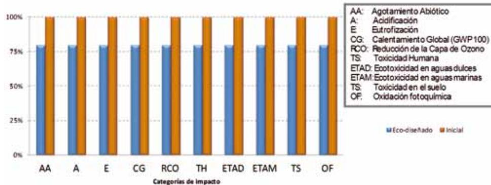
Figura 23. Comparación del impacto asociado a la fase de uso entre componente inicial vs prototipo mediante la metodología CML 2 baseline 2000 V2.05 / West Europe, 1995.
