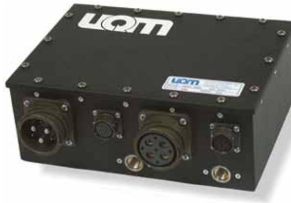
Figura 3. Inversor DD40-100L (25 kW nominal) de UQM.
