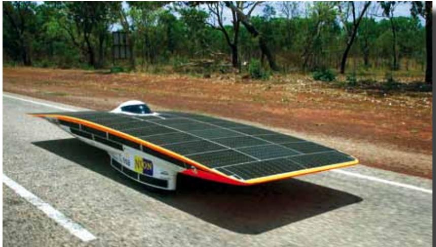
Figura 6. Coche solar Nuna 3 participando en el World Solar Challenge (velocidad media 90 km/h, 6m<sup>2</sup> de células solares).
