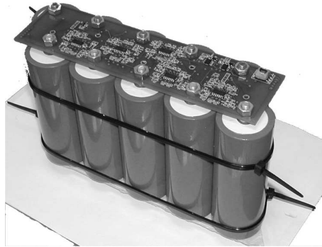
Figura 2. Prototipo de módulo de batería con el monitoreo del estado del sistema y balanceo de carga de las células con un BMS.
