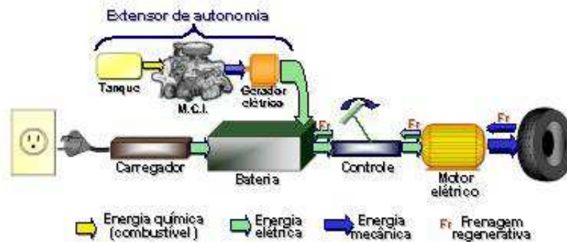
Figura 8. Representación gráfica del extensor de autonomía para un vehículo eléctrico: [Fuente: http://www.chevyproductreport.com/tag/jersey-city-chevrolet-dealer/ ]
